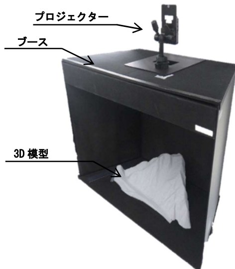
図-4 試作したマッピングシステムの外観図
