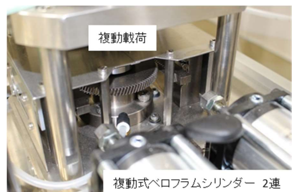
写真-2 複動空圧載荷装置
