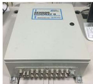
図-2 AE 放射器
