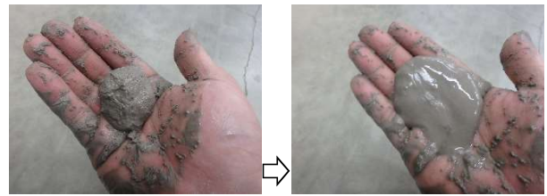
図-6 K-Ah(Oita)の揺すった状況(攪乱試料)
