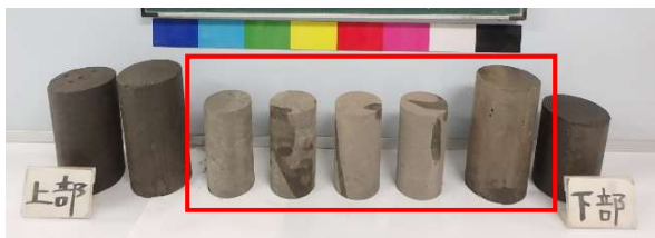
図-2 不攪乱採取試料 K-Ah(Oita)
