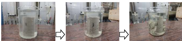
不攪乱試料：水浸直後→1週間後(維持)→2週間後(崩壊)
