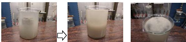
攪乱試料：水浸直後→5分後(崩壊)
