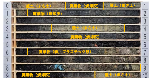
写真-2 調査地の埋設廃棄物(焼却灰主体)
