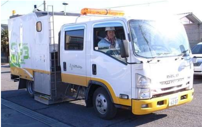
写真-1 路面下空洞探査車
