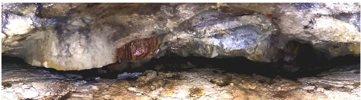
写真-1 全天球カメラで撮影した全方位画像(写真中央が下流方向、空洞幅 30cm)
