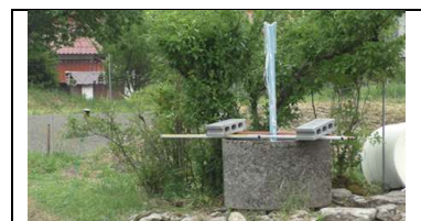
図-3 PDV の設置状況(スポンジなし)
