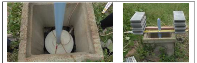
図-2 PDV の設置状況(スポンジあり)
