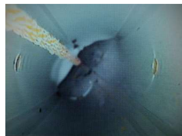
写真-1 孔内傾斜計ガイドパイプの屈曲 (S23-1 孔 GL-3.2m 付近)
