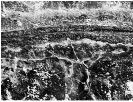
写真-3 フィルターを使用したひび割れ箇所の抽出例
