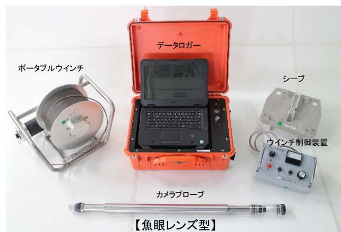
写真-1 従来型、及び魚眼レンズ型の基本構成
