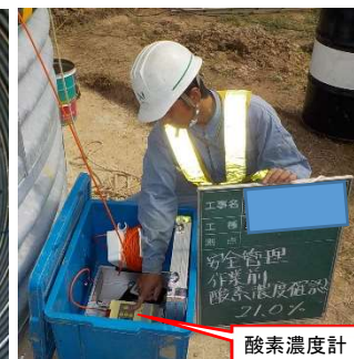
写真-4 酸素濃度測定
