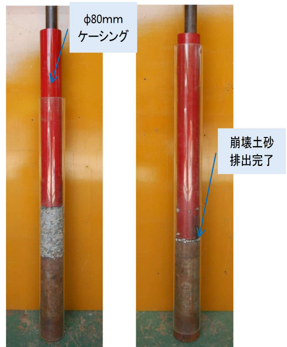
φ80ケーシング 崩壊土砂削孔
