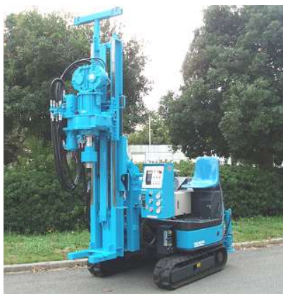
写真-1 振動式ボーリングマシン(一例)
