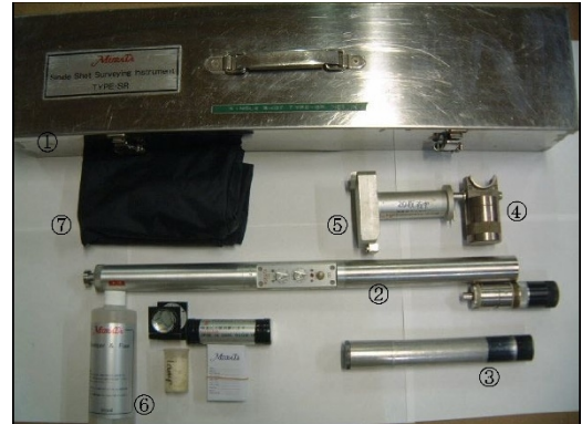
図-7 村田式坑井記録傾斜儀(株式会社 村田製作所) 3)
