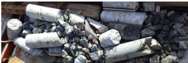
写真-1 盛土に用いられている岩塊の採取コア
