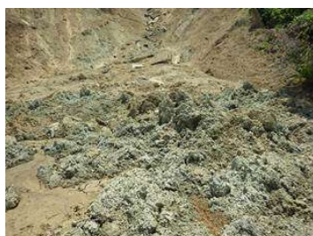
写真-2 崩壊土砂(汚泥)
