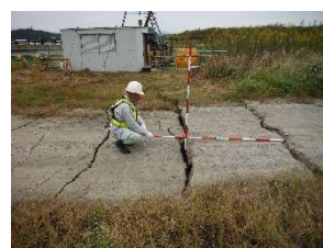
写真-3 地表の亀裂
