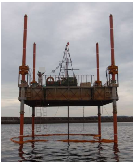
写真-1 海上調査に使用する一般的なスパッド台船
