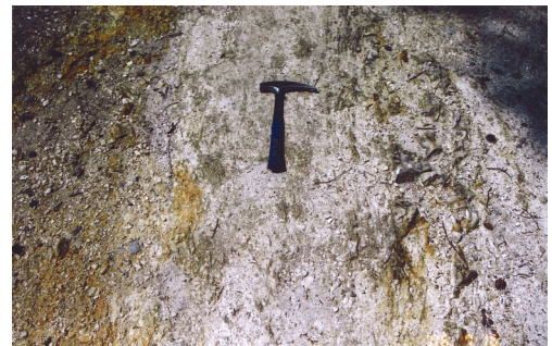
図-8 山頂の熱水変質帯(最大幅1.7m×長さ9.0m) N5～10° Eの節理方向に分布
