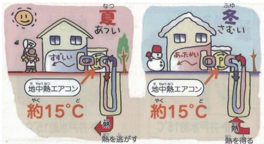
地下水の温度を用いた冷暖房
