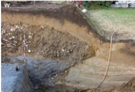
新潟県中越地震の震源断層で行われたトレンチ調査。地層の食い違いが断層。このような地層のずれから過去の地震がどのようなものであったかを調べます。
