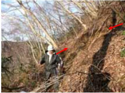
写真12 上部斜面に生じた滑落崖(赤矢印間)
