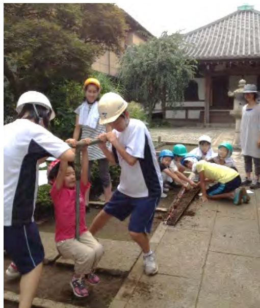
図3 子供たちの地層掘削と観測・測定 中心に荷重をかけながらハンドオーガーを回転させる子供たち。採泥器の一度の「上げ下げ」で約30cmのコアが採れる。右奥：採取された試料は半割の雨どいに連続して並べられ、地温の測定とコア記載を行った。
