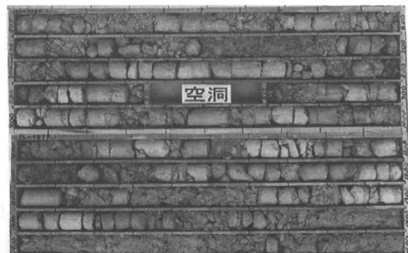
写真1 探査異常箇所確認ボーリングコア写真(部分)
