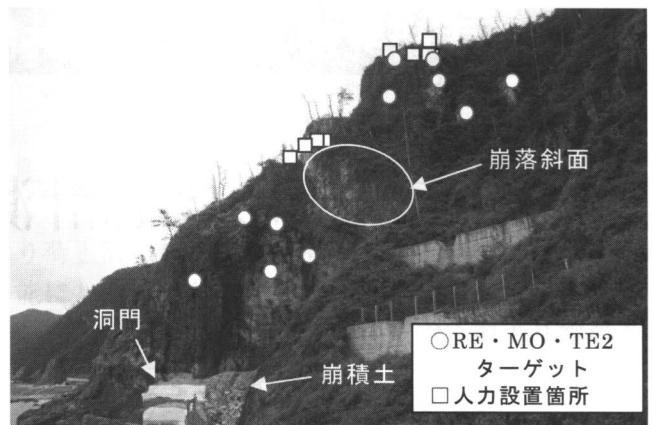
図3 地震により岩盤が崩落した斜面での実施例
