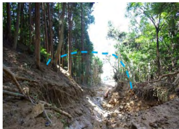
図-2 流下痕跡 (立木に着いた泥の高さ) から推定した流下時の土石流の形 (破線)
