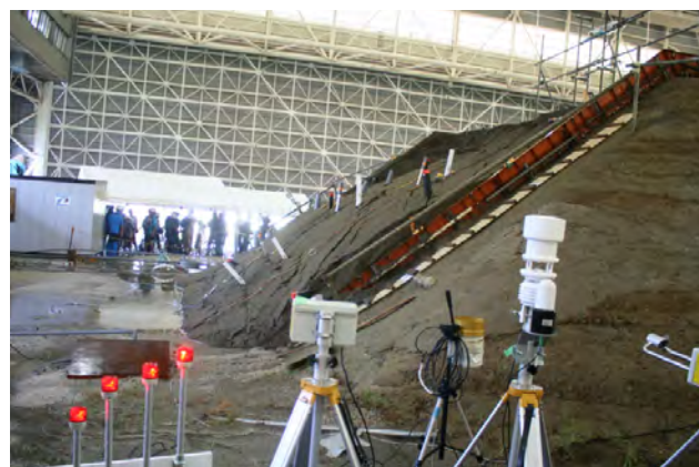
写真 6 崩壊後の実験状況と計測状況
