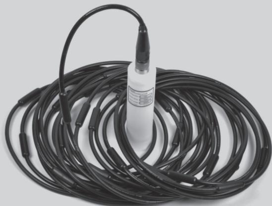
本装置は、RBR Limited 社（カナダ）により開発された高精度・高分解能、かつ長期安定性を実現した多点温度センサストリングです。
