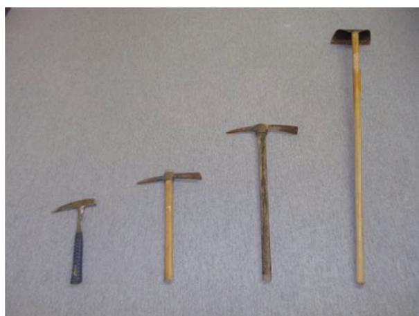
写真-2 右から立鎌，魚沼ハンマー，十字鋏，ピック・ハンマー
