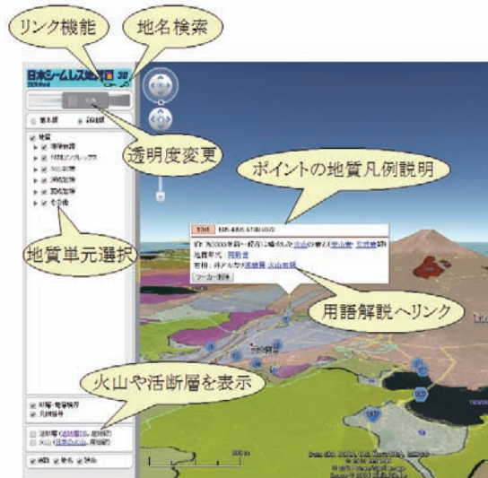
第 3 図 シームレス地質図 3D の表示画面と基本的な機能
