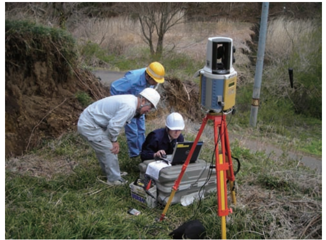
図7 地上レーザ測量の様子
