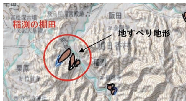
図-2 稲渚の棚田と地すべり地形（出典：地すべり地形分布図 Web-GIS；（独）防災科学研究所）
