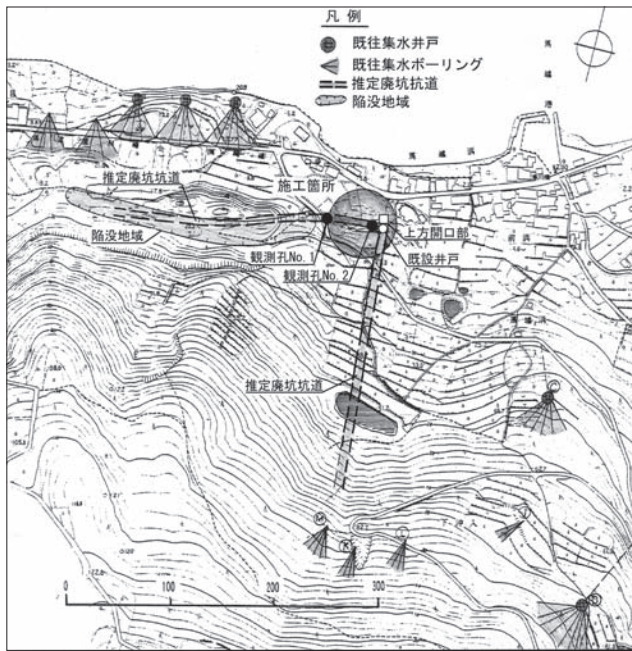
図3 地形状況（平成17年度 県営馬越地区地すべり防止施設補修工事 設計図書資料：馬越地区地すべり区域平面図 香川県農林部土地改良課 昭和43年発刊）
