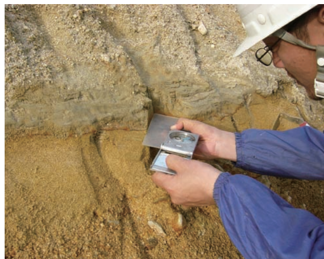
写真-3 地質境界の姿勢（走向傾斜）を測る
